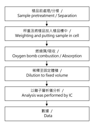
鹵素分析流程圖 / Analytical flow chart - Halogen
